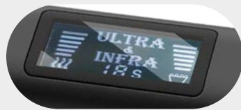
DISPLAY CON INDICACIÓN DE TIEMPO (ABAJO) E INTENSIDAD DE INFRARROJOS (IZQUIERDA) Y ULTRASONIDOS (DERECHA)
