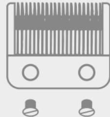
**(1)** El extremo de los dientes de la cuchilla superior debe estar entre 0,5 y 1 mm por detrás de la cuchilla inferior. Esto es importante para que la maquinilla no corte demasiado cerca ni permita que la cuchilla en movimiento toque la piel.
