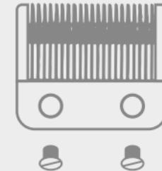
**(1)** Das Ende der Zähne der oberen Klinge sollte 0,5 bis 1 mm hinter der unteren Klinge liegen. Dies ist wichtig, damit der Rasierer nicht zu nah schneidet oder die bewegliche Klinge die Haut berührt.
