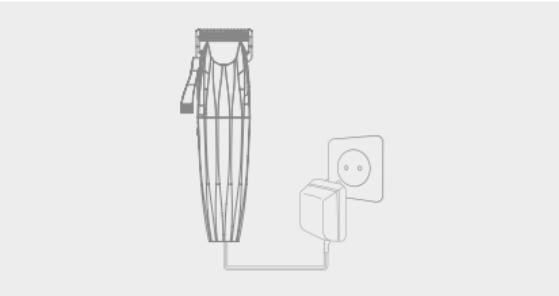
Branchez le câble du chargeur dans le connecteur situé à la base de la machine.
