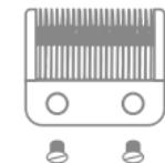
(1) A extremidade dos dentes da lâmina superior deve estar 0,5 a 1 mm atrás da lâmina inferior. Isto é importante para que a lâmina de barbear não corte demasiado perto nem permita que a lâmina em movimento toque na pele.
