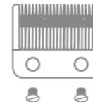
(1) L'extrémité des dents de la lame supérieure doit se trouver de 0,5 à 1 mm derrière la lame inférieure. C'est important pour que le rasoir ne coupe pas de trop près et que la lame en mouvement ne touche pas la peau.
